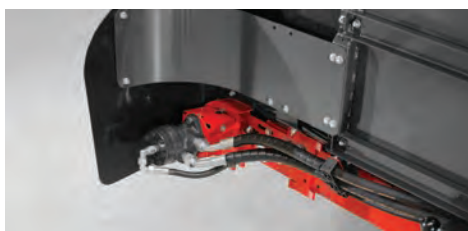
měr a rychlost dopravního pásu lze snadno měnit díky ovládní hydromotoru.
