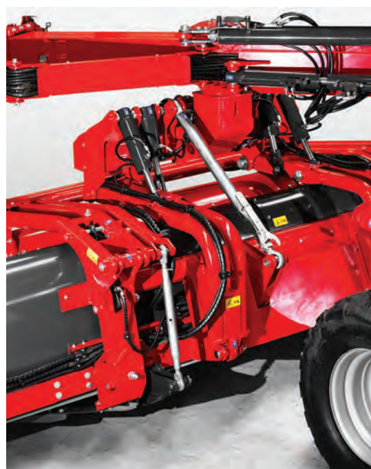
Hydropneumatické odlehčení sběrače zajišťuje vynikající kopírování terénu
