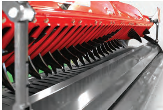
Prstový rotor se sběračem zajistí perfektní tok píče strojem.
