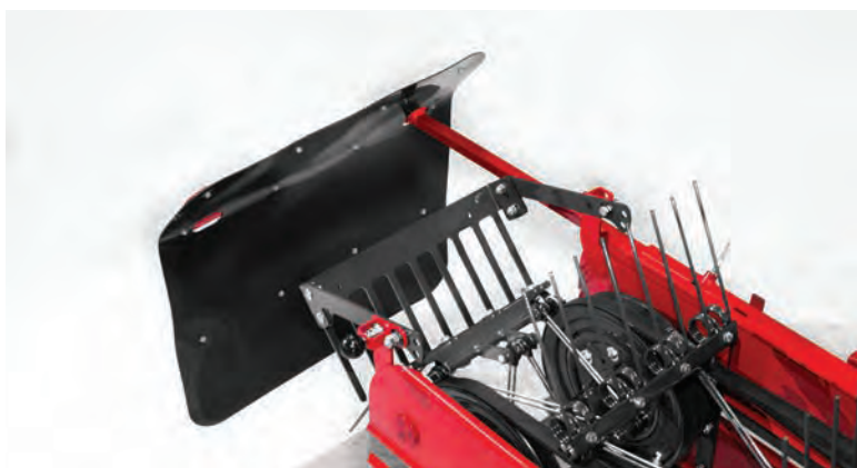
Řádkovací plachta je na stroji neustále. Zvednutím plachty se mění řádkování v obracení a naopak (hydraulické nastavení na přání). Protisměrné shrnování (na přání) brání nahrnování velkého množství píce.
