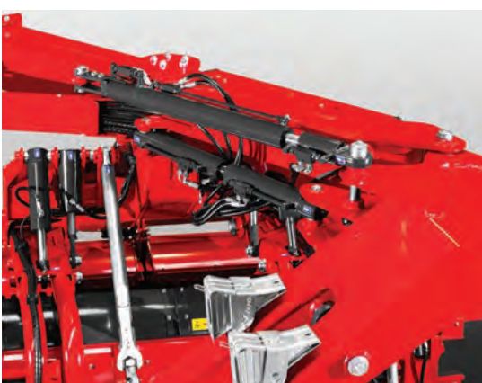
Hydraulický systém na přepravním rámu umožňuje sběrací zařízení otočit z přepravní do pracovní polohy a buď vpravo nebo vlevo od traktoru.
