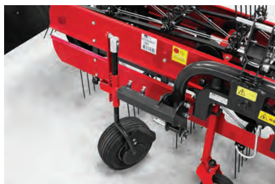
Dvojitá vodící kola umožňují perfektní kopírování terénu a vyšší pojezdovou rychlost.
