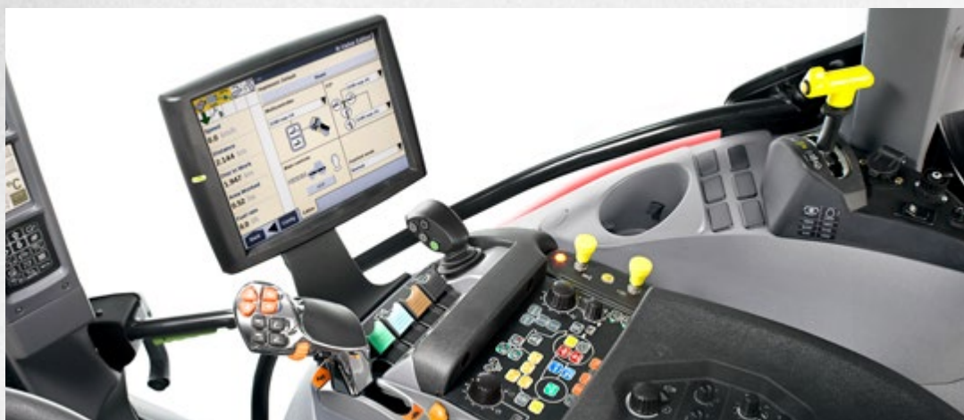
Profi a Profi CVT jsou vybaveny až 4 elektrohydraulickými okruhy.
