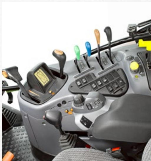
Profi Classic vybavený mechanickými vnějšími okruhy a elektrickou regulací TBZ (EHR).
