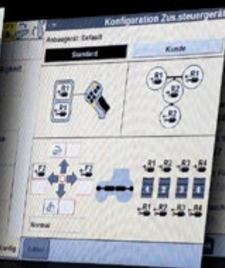
Definuje tlačítka pro činnost řídicích jednotek
