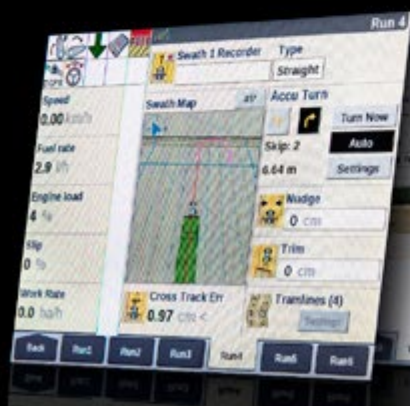
Systém S-TURN automaticky otáčí stroj na konci řádku
