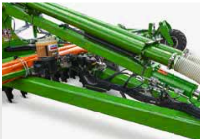
Systém centrálního mazání na stroji Catros + 12003-2TS
