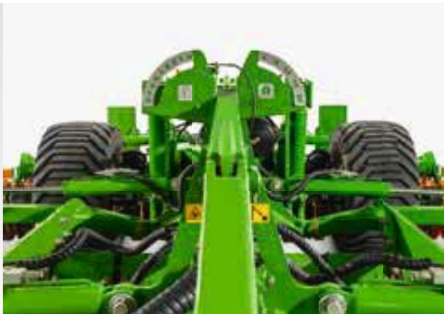
Ukazatel pracovní hloubky srovnávací lišty „crushboard“ (vlevo) a diskové sekce (vpravo)
