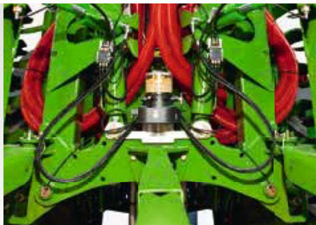
Elektrický systém centrálního mazání na stroji Catros s balíčkem „pro“
