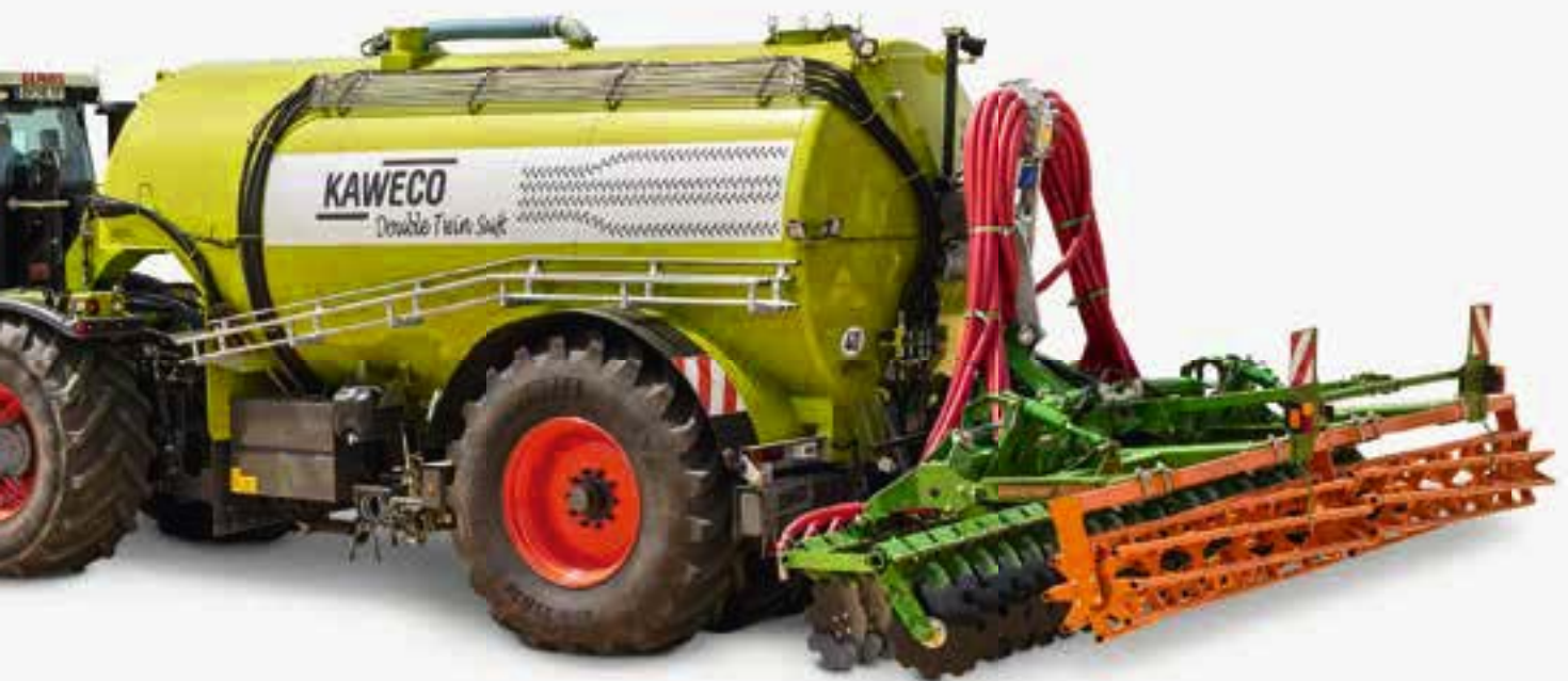
Catros + 5002-2 s balíčkem „pro“ a centrálním mazáním a aplikátorem kejdy
