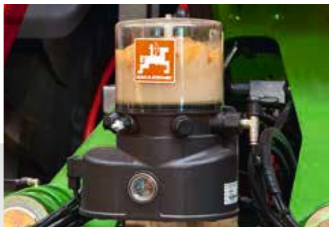
Čerpadlo se zásobní nádrží
