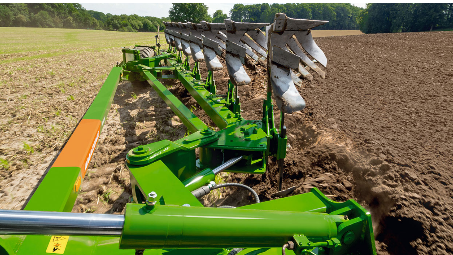
Hektor s jištěním proti přetížení prostřednictvím střížného šroubu
