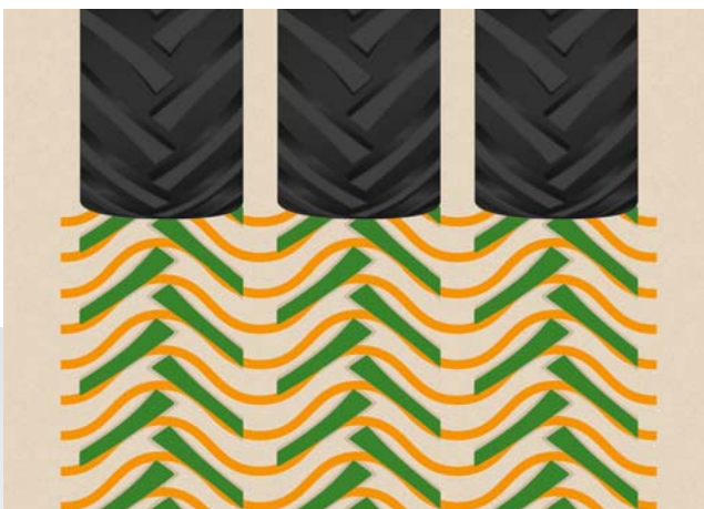
Vlastní pohon zajišťují šípové pneumatiky
