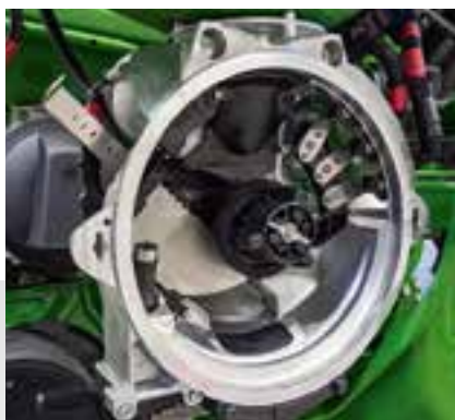
Pohled do dávkovací komory bez dávkovacího kotouče
