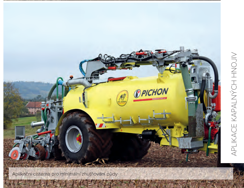
Přívozní cisterna s přepouštěcím trychtýřem
