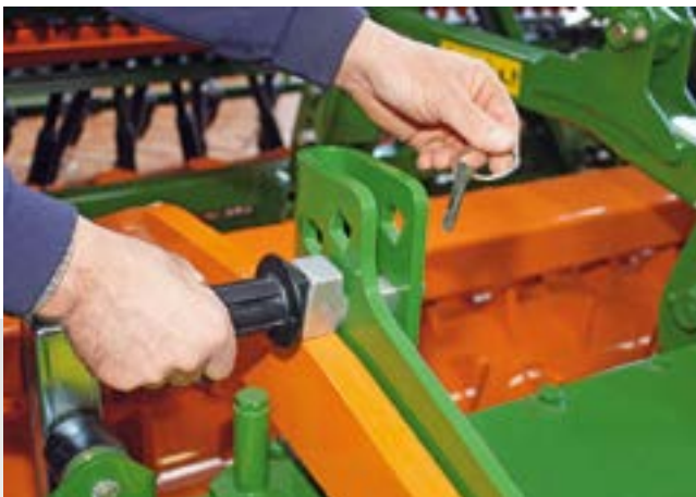
✔ Mechanické nastavení hloubky
