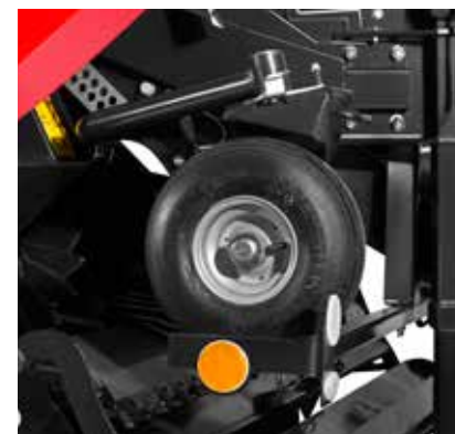
Transportní poloha kopírovacích koleček sběrače
