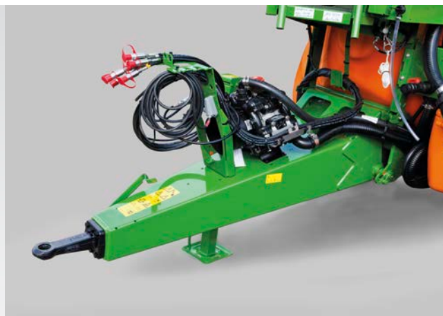
Spodní připojení s vlečným okem a mechanickou opěrnou nohou
