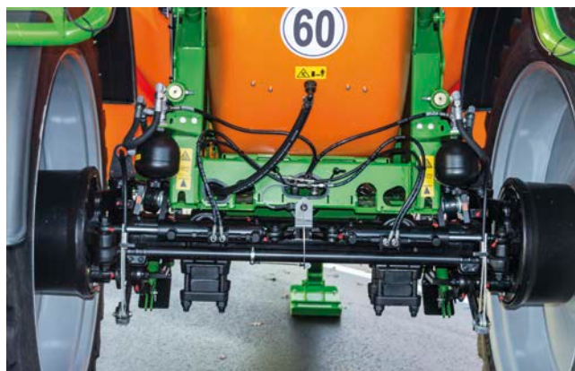
Hydropneumatické odpružení nápravy s řízením nápravy AutoTrail
