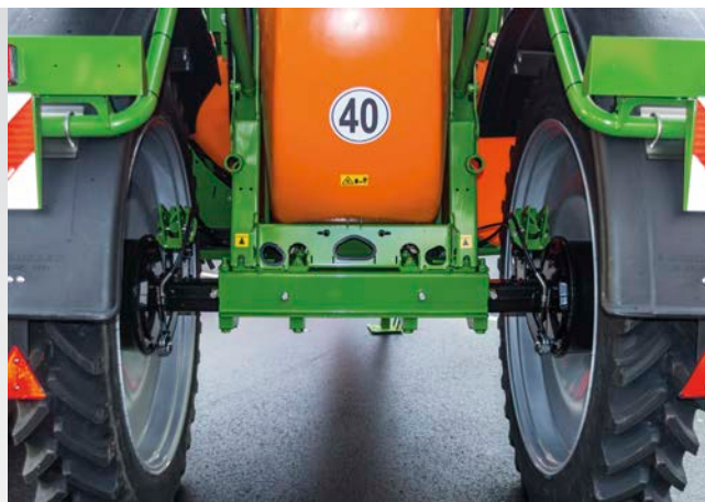
Stavitelná náprava s plynulým nastavením rozchodu od 1,50 do 2,25 m
