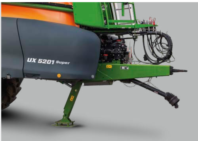
Horní připojení s vlečným okem a hydraulickou opěrnou nohou
