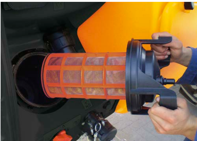
Sací filtr lze v případě naplněné nádrže otevřít a vyčistit, aniž by vytekla jícha.
