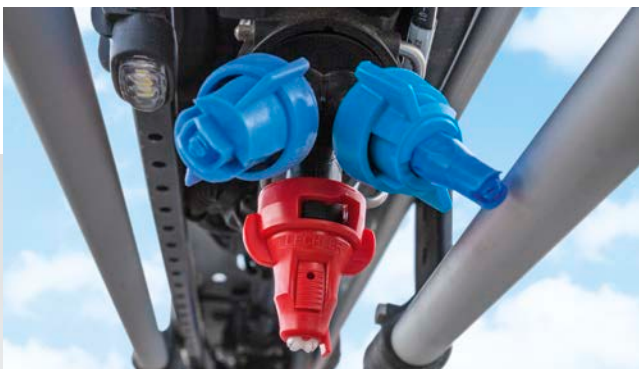
✓ Elektrické spínání jednotlivých trysek AmaSwitch
