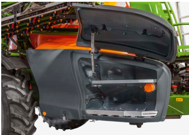
Odkládací schránka o objemu 240 l na pravé straně stroje
