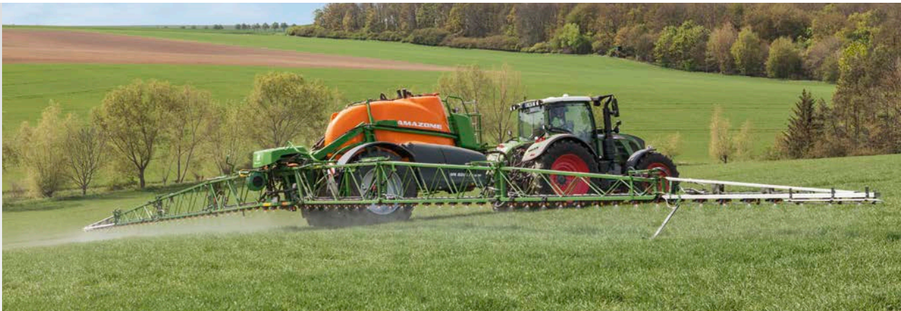
ContourControl s nakloněním ramen směrem dolů
