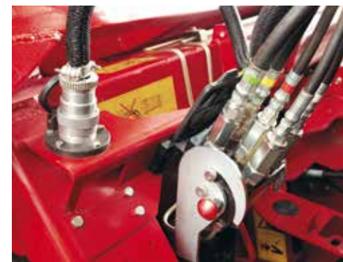
Připojit žací lištu je otázkou několika málo minut díky rychloupínacím konektorům.
