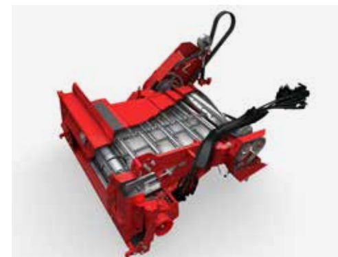
Užijte si ovládání žacího adaptéru o záběru 9.15 m s pístnicemi o průměru 80mm
