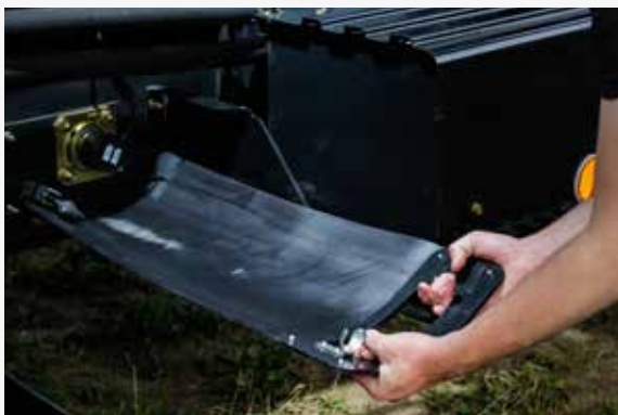
Odnímatelné dno šnekových dopravníků
