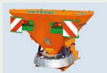
Rozmetadlo pro zimní údržbu komunikací E+S 300–1000 l
