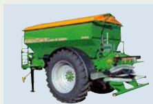
Velkoplošné rozmetadlo ZG-B 5500–8200 l, 10–36 m
