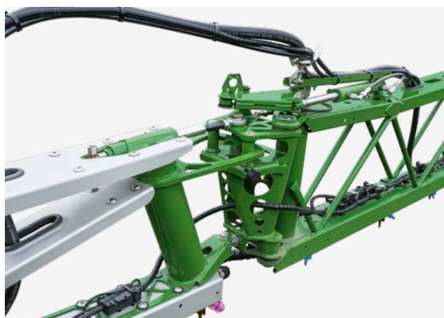
Hydraulicky ovládaný kloub na koncové části ramen s funkčním principem lítačkových dveří
