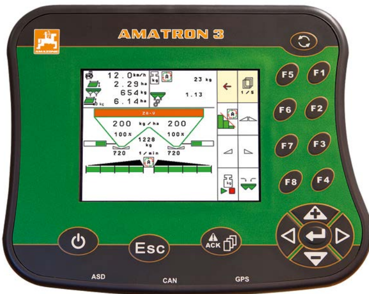
AMAZONE AMATRON 3 Velká obrazovka o velikosti 5,6"
