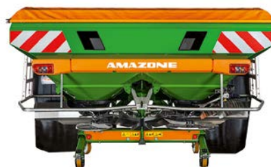
Nástavba L 2700 (šířka plnění 2,71 m) se sklopnými žebříky
