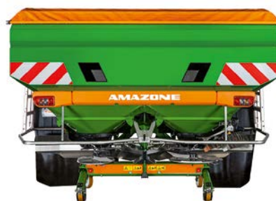
Nástavba L 4200 (šířka plnění 2,71 m) se sklopnými žebříky
