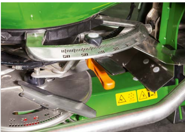
Stavěcí páka s velkou stupnicí
