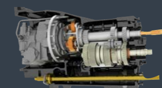
Plynulé převodové ústrojí z 0 na 50 km/h
