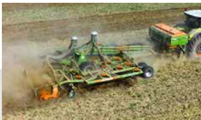
XTender 4200 s kypřičem Cenius 6003-2TX a dvěma semenovody pro aplikaci hnojiva a osiva
